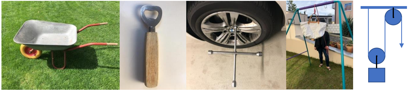
Abbildungen von links nach rechts – Schubkarren, Flaschenöffner, Radschlüssel, Seil, Flaschenzug Für alle Kraftwandler gilt die Goldene Regel der Mechanik :
